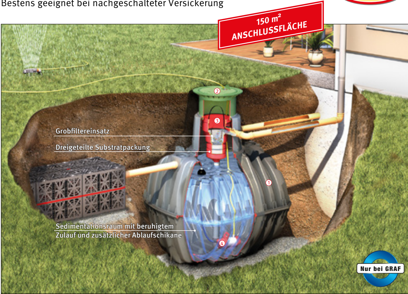
Abbildung zeigt Carat Regenwassertank mit EcoPure 150 und Technikpaket Garten-Komfort (Zubehör Seite 60)
