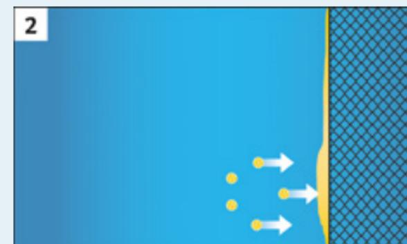
Damit diese kleinen Öltröpfchen aufsteigen können, besitzt der Leichtflüssigkeitsabscheider System A eine Koaleszenzeinheit an der sich die kleinen Öltröpfchen sammeln können.
