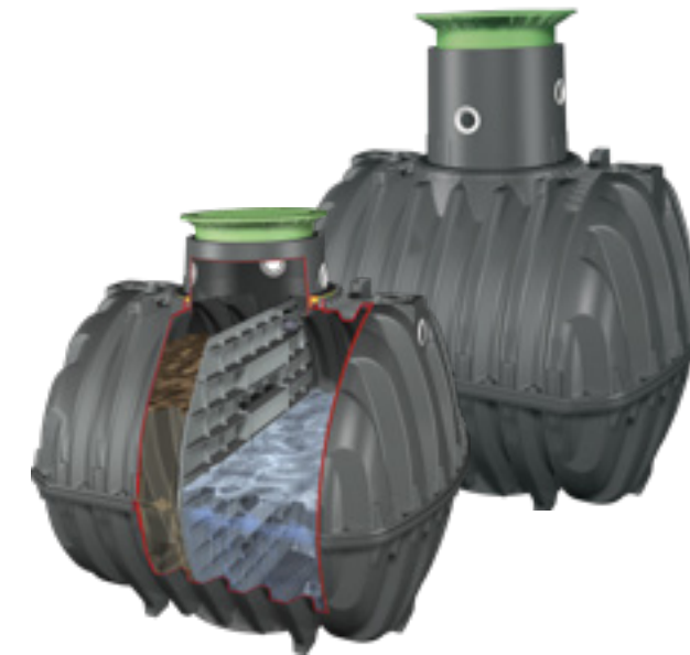
Abbildung zeigt Carat Klärbehälter 4.800 l mit Trennwand, Tankdom Mini und Teleskop-Domschacht 600 Mini begehbar (vorne) bzw. Tankdom Maxi (hinten)
